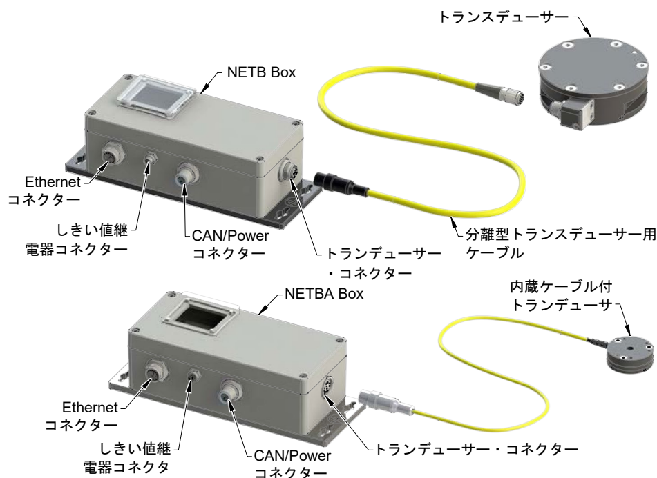
図 3-1 – Net F/T システムのコンポーネント
